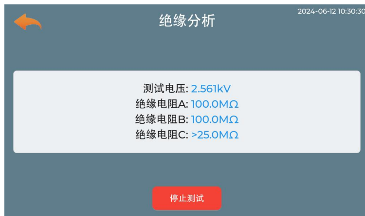
图 6.6 绝缘测试过程
